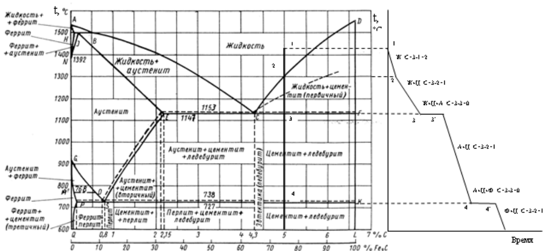
Рисунок. Диаграмма состояния системы железо - цементит (слева) и кривая охлаждения чугуна, содержащего 5% углерода (справа)
