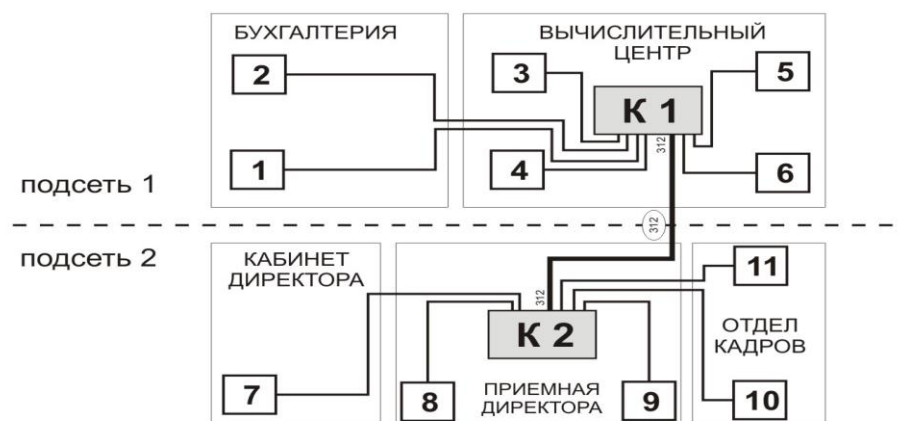
Рисунок 4.1 – Схема локальной сети
