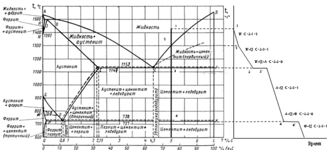
Рисунок. Диаграмма состояния системы железо - цементит (слева) и кривая охлаждения чугуна, содержащего 5% углерода (справа)
