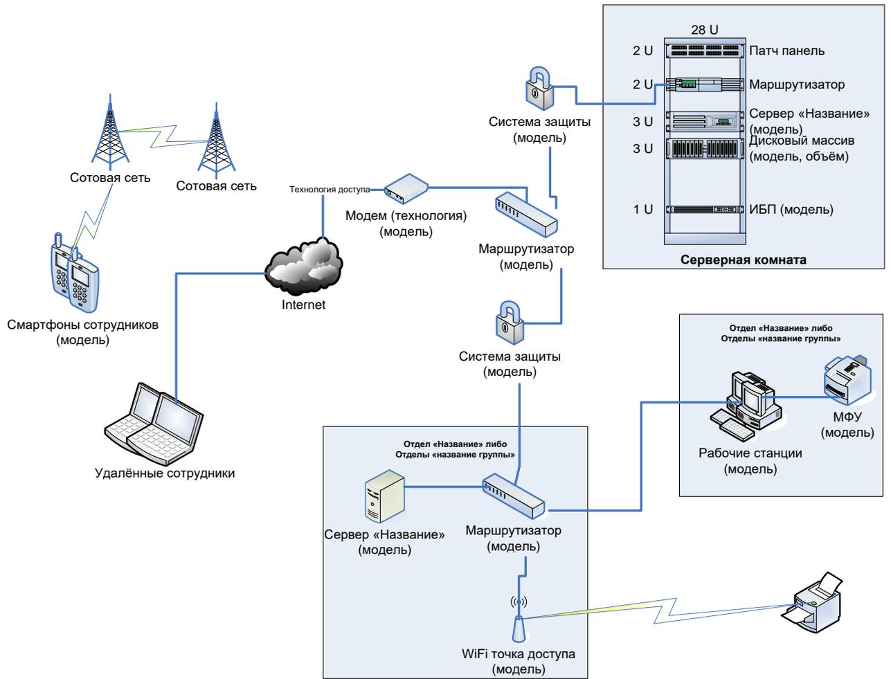
Рис.2. Пример технической архитектуры предприятия
