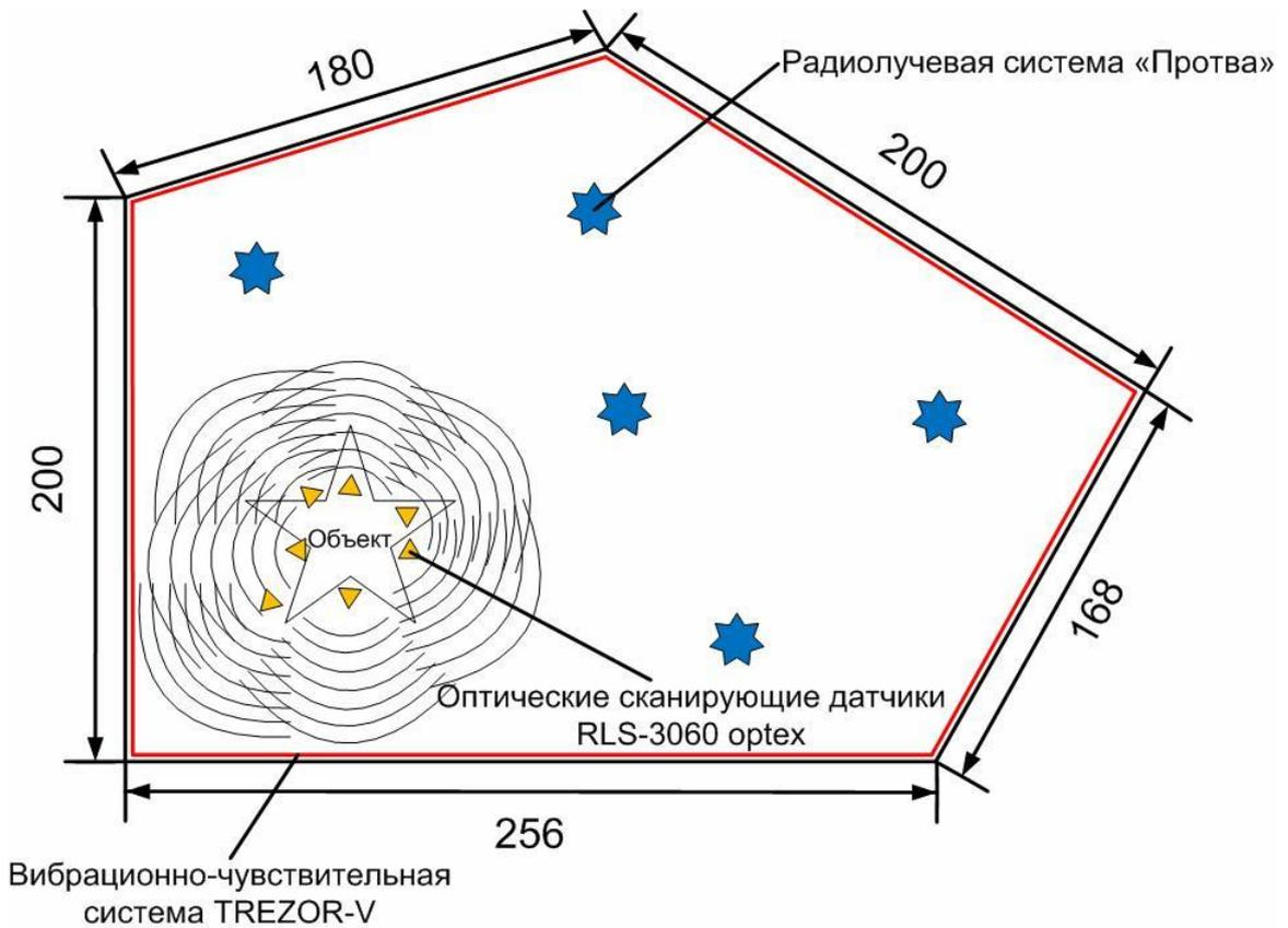
Рис. 7. Расположение систем контроля периметра (вариант 2)
