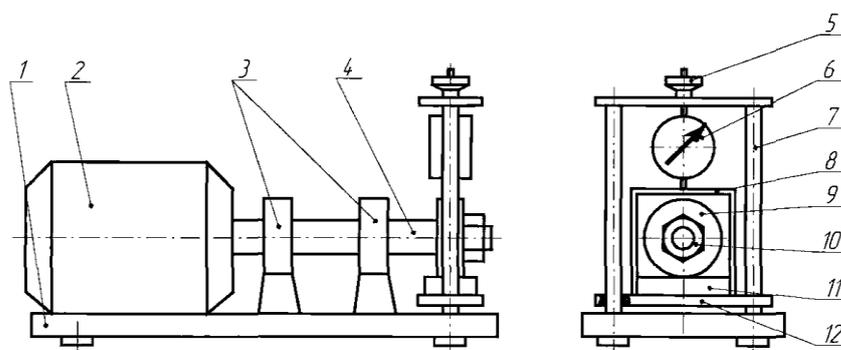
Рис. 2 Схема установки для ускоренного испытания на абразивное изнашивание
