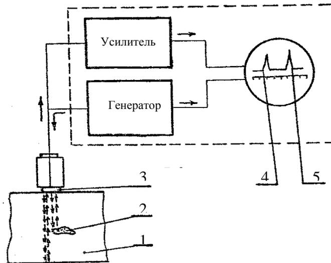
Рис. 2 Блок-схема импульсного ультразвукового дефектоскопа при работе с нормальной искательной головкой:
