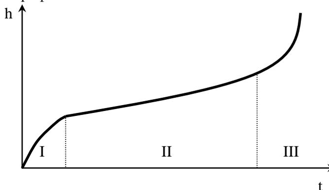
Рис. 1 Схема изменения износа  $h$  от времени  $t$
